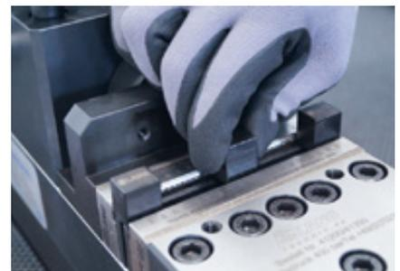
Passt der Messstein nun zwischen die Prägezähne, sollten die Backen zur Nacharbeit eingesandt werden.
