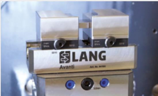
Ob längs oder quer gespannt – Im patentierten Schnellwechselbackensystem können verschiedenste Konturen bei optimaler Zugänglichkeit aufgenommen werden. Durch das maximal nutzbare Volumen der Aufsatzbacken ist zudem auch die Einbringung verschiedener Konturen in einem Backenpaar möglich.
