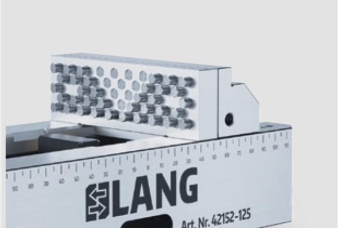
Nicht benötigte Stifte werden einfach per Hand zurückgedrückt. Die übrigen Stifte dienen als Anschlag- und Auflagemöglichkeit für das Werkstück. Parallelunterlagen oder externe Werkstückanschlüge, die die Zugänglichkeit negativ beeinflussen, werden somit nicht benötigt.
