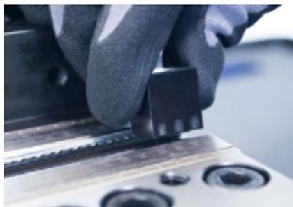
Achten Sie darauf, dass die Prägezähne in den Nuten der Prüfsteine platziert werden.
