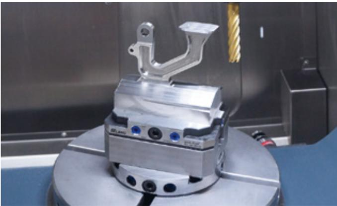
Ohne Schraubstock wird das Werkstück direkt und sicher im Nullpunktsystem gespannt.
