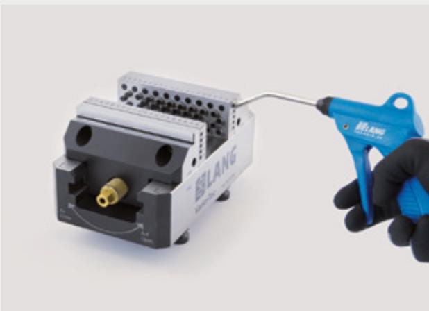
Um die Funktion der Stifte jederzeit zu gewährleisten, sollten diese nach Ende jeder Bearbeitung herausgeblasen und mit Druckluft gereinigt werden, um ein Verharzen durch Kühlmittel zu vermeiden. Das gelegentliche Einsprühen mit Multifunktions-Öl für die Gleitfähigkeit der Stifte ist empfehlenswert.
