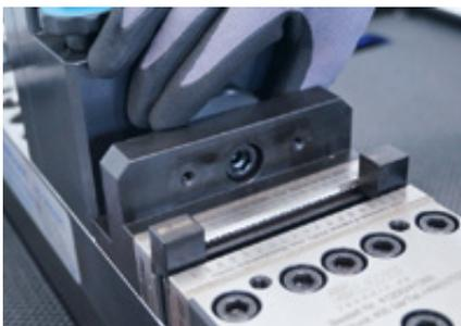
Platzieren Sie die mit den Aussparungen versehenen Steine an den äußeren Enden der Prägebacken und klemmen Sie diese von Hand leicht fest.
